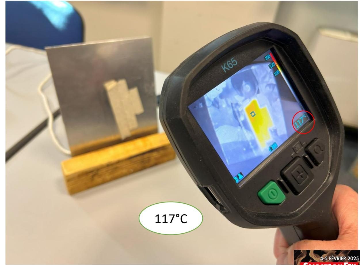
Tôle chauffée à 120°C
