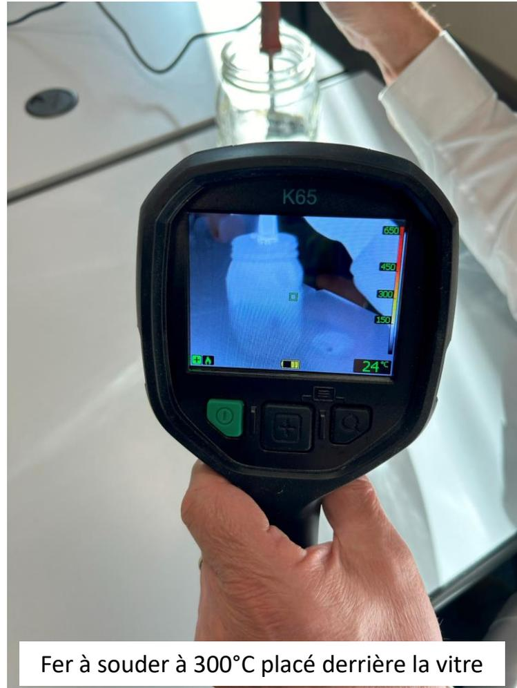
Fer à souder à 300°C placé derrière la vitre
