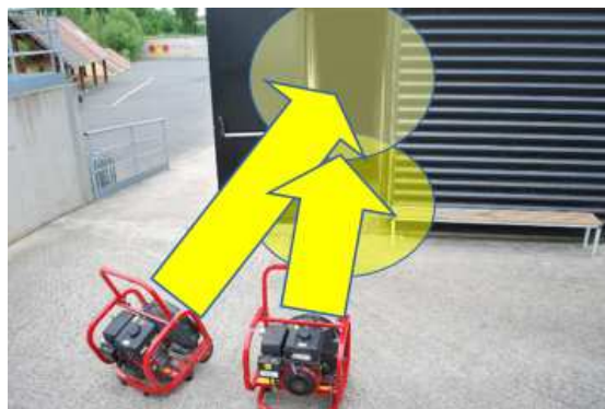
Illustration n°3 : Optimisation de la direction du flux avec deux ventilateurs. Le plus puissant étant orienté vers le haut
