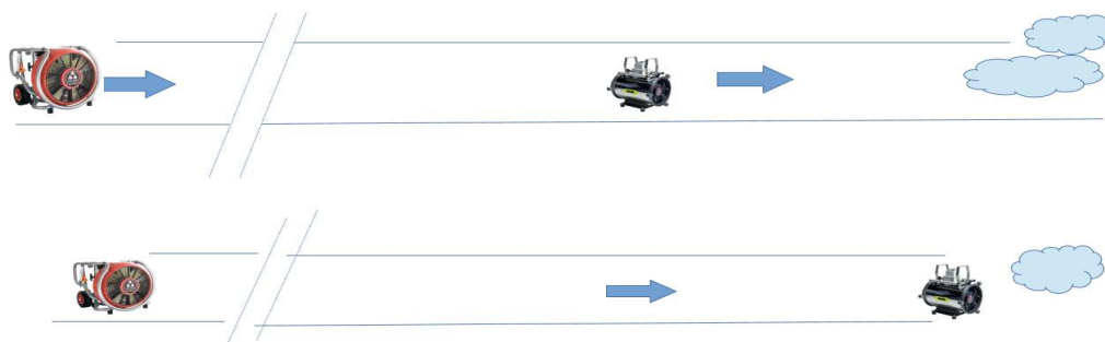
Illustration n°8 : Principe d'utilisation de ventilateurs en relais
