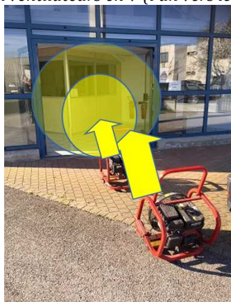
Illustration n°5 : Utilisation de deux ventilateurs l'un derrière l'autre
