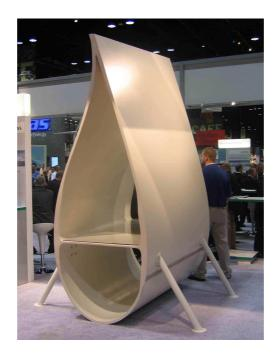
Ces matériaux dégagent des composés organiques volatiles, tel que le styrène. A ce titre, un engagement opérationnel à l'intérieur d'une pâle nécessite une protection respiratoire adaptée.
