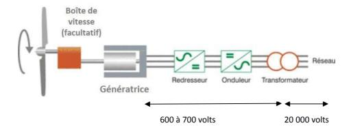
La puissance des éoliennes modernes est de 0,7 à 4 MW en milieu terrestre. Les éoliennes sont prévues pour des vitesses de vent comprises entre 4 et 30 m/s. Au-delà, un dispositif de freinage aérodynamique ou mécanique arrête automatiquement l'éolienne afin de sécuriser les équipements et d'en minimiser l'usure. C'est autour de 14 m/s que les éoliennes modernes fournissent leur puissance nominale.
